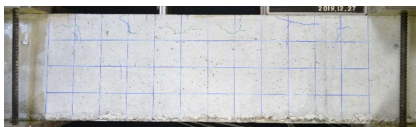
Level.1 (加力前最大ひび割れ幅 0.05\text{mm} )
