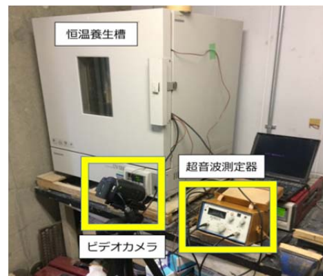
写真-1 恒温養生槽
