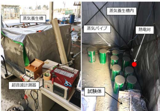
写真-2 蒸気養生槽
