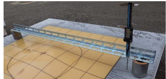
写真-3 残留隆起高さの計測状況
