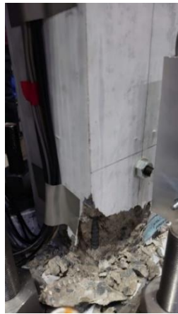
写真-3 最終破壊状況 (X1-Y1 通り 1階柱 C1)
