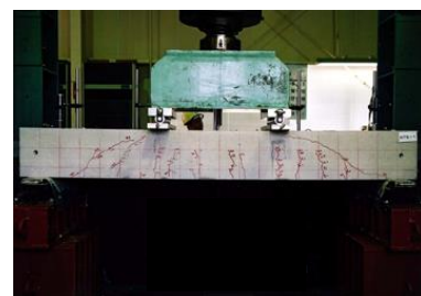
図-7 基準試験体の破壊状況
