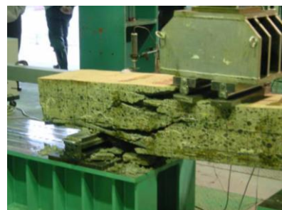
図-11 ASR2 試験体破壊時の支点付近の状況
