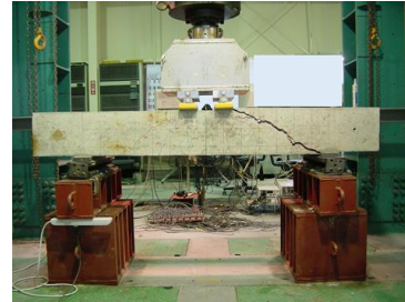
図-12 基準試験体の破壊状況
