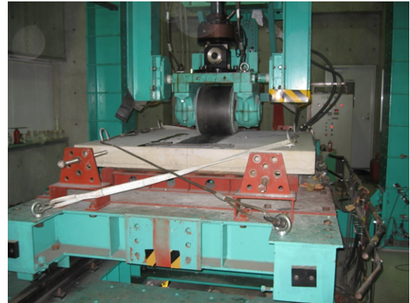
写真-3 輪荷重走行装置
